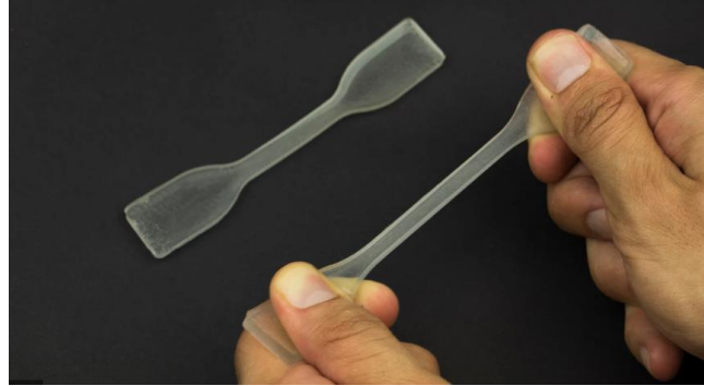
الشكل (3): قابلية التشوه الكبيرة للمطاط تحت تأثير الشد
