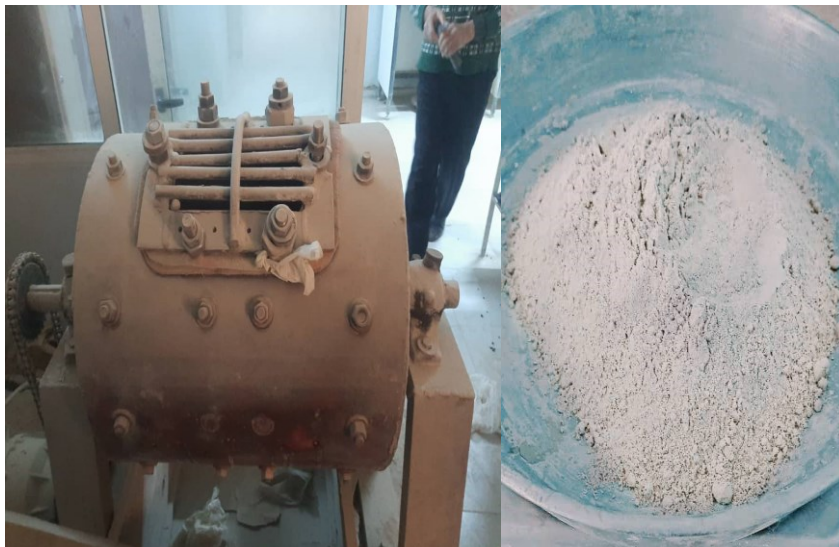
الشكل (3): جهاز طحن الزجاج، عينة من الزجاج المطحون
