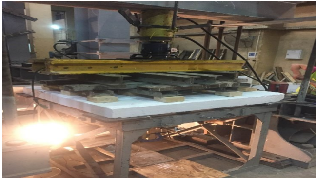
الشكل (5): آلية تطبيق الاختبار للبلاطة في دراسة [1]
