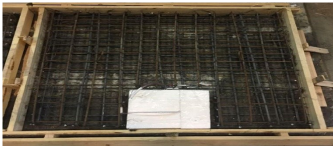
الشكل (6): تفاصيل البلاطات المختبرة: التسليح الداخلي والخارجي المختبرة [1]
