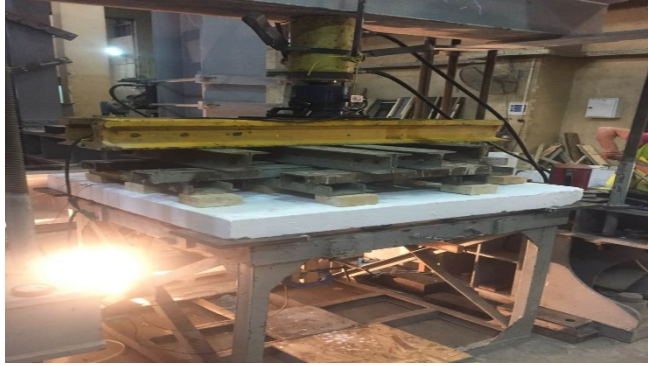
الشكل (5): آلية تطبيق الاختبار للبلاطة في دراسة [1]
