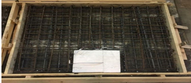
الشكل (6): تفاصيل البلاطات المختبرة: التسليح الداخلي والخارجي المختبرة [1]
