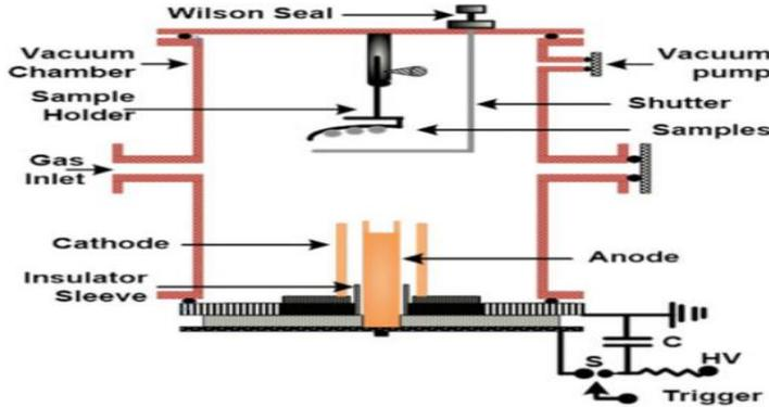
الشكل (1): مخطط جهاز البلازما المحرقة الكثيفة المستخدم في ترسيب الأفلام الرقيقة [1]
