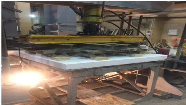
الشكل (5): آلية تطبيق الاختبار للبلاطة في دراسة [1]
