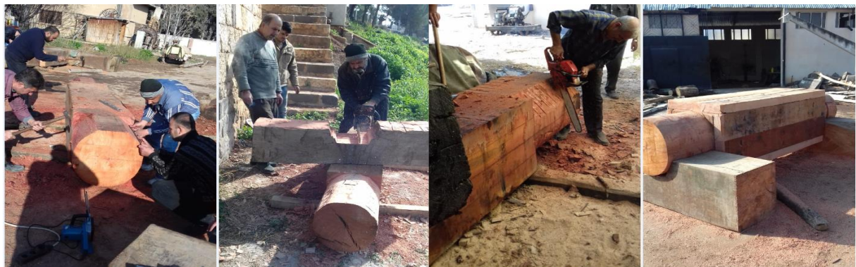
الشكل (5) : صناعة القلب الدوار ومقر الدوران الخشبي يدوياً
