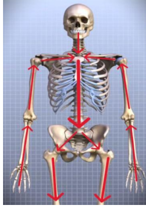
الشكل (٤): رسمة توضح انتقال الحمولات بشكل مبسط
